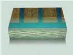
Mikroskop-Aufnahme einer Schnittkante: Glatte Oberfläche, schneller Schnitt mit dem PicoLine-System. Foto: LPKF
