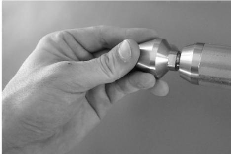
Führen Sie die Reflektorspitze zum Innengewinde der Austrittsdüse und schrauben Sie diese vorsichtig per Hand bis zum Anschlag ein.
