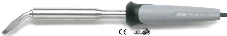
Die bewährten LötKolben der Serie **ERSA 50 S / 80 S / 150 S** sind ausgelegt für Lötarbeiten mit größerem Wärmebedarf, wie zum Beispiel an Kupferleitern mit Querschnitten von 2,5 mm<sup>2</sup> (ERSA 50 S, 50 W) bis 6 mm<sup>2</sup> (ERSA 150 S, 150 W).
